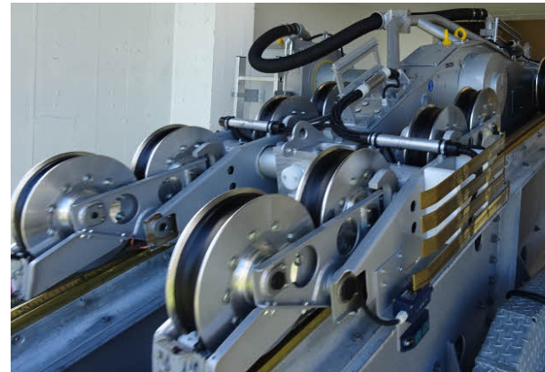
Frey Austria lieferte mit Partner Siemens den Antrieb und das Steuerungssystem. Zentimeterarbeit: Die aufwändige Seilbahntechnik musste in den bestehenden Gebäuden integriert werden – so passt das 16-rollige Laufwerk bis knapp unter die Gebäudedecke.
