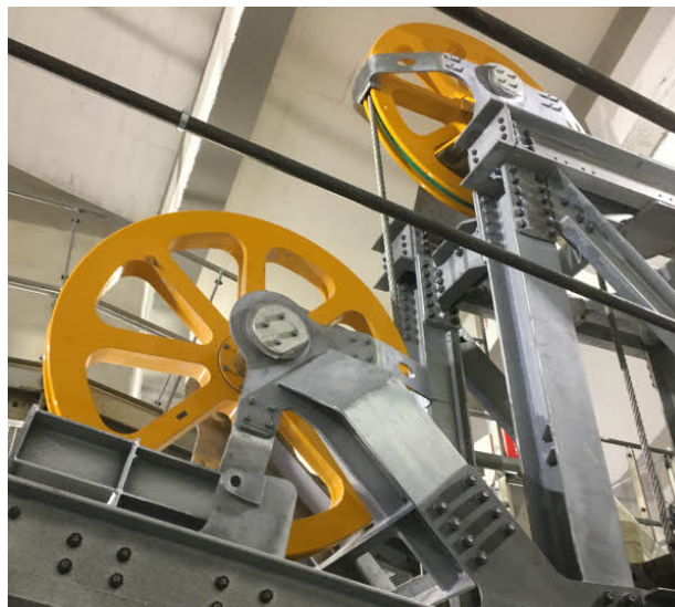
Die Tragseile sind fix auf einem Poller abgespannt - die Gewichtsabspannung des Zugseils erfolgt über einen Spannturm im Talstationsgebäude. Der Salzburger Ticketing-Spezialist Axxess lieferte das Zutrittsystem für die neue Seilbahn.
