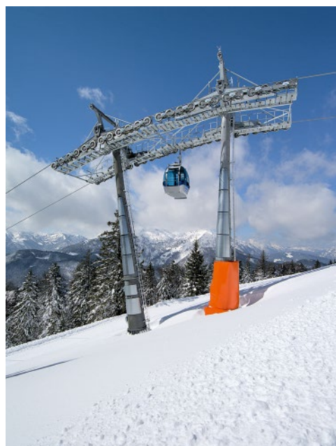
In der Mittelstation treibt das untere Seil die obere Seilschleife über eine zweirillige Scheibe an. Diese Lösung ist seilbahntechnisch interessant und kostengünstig.
